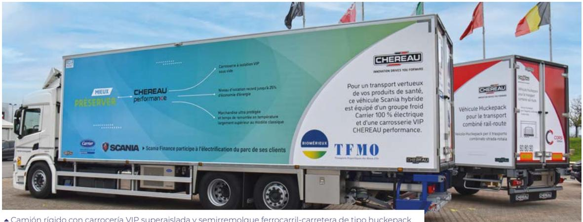
▲ Camión rígido con carrocería VIP superaislada y semirremolque ferrocarril-carretera de tipo huckepack.
